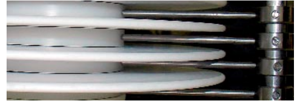
Bild 6 Stromstörerleiste zur Erzeugung von zusätzlicher Turbulenz
